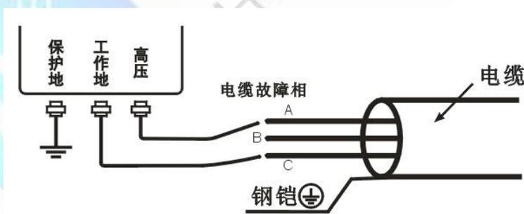
图 3-1-2 相间故障接线示意图
