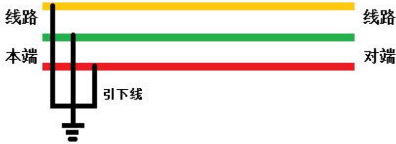
图 6-3 将被测线路本端引下线接地
