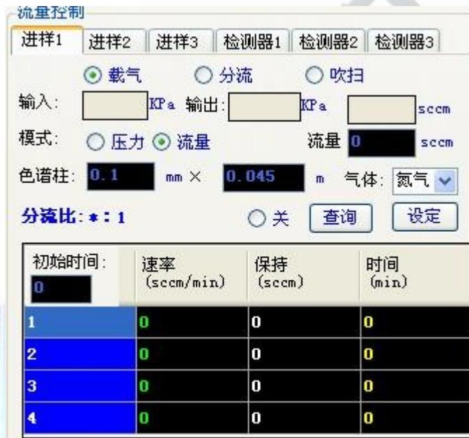
单击流量控制下面的各路图标如上图进样 1 则会显示该气路的运行情况，击相应设置区的数值，修改数字，按“设置”即可。实测值是仪器实际测出的数值，不可更改。
