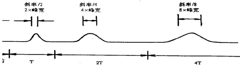
图8 采用变参时间自动变更斜率和峰宽
