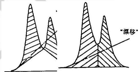
图4 “漂移”设定引起的面积求法的差异
