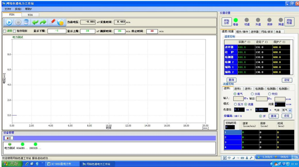
界面的上方是下拉式菜单；下拉式菜单下方是检测器的运行参数和屏幕显示参数；中部是谱图数据显示区；最下方是气相色谱分析仪状态指示区；右面是气相色谱分析仪的运行参数。左下角显示了通信服务连接状态是否成功。
