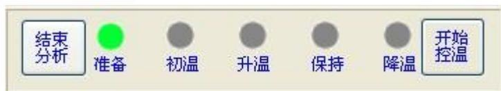
单击开始控温即启动这台气相色谱分析仪开始控温及 EFC 模块的工作，同时图标会自动变成
