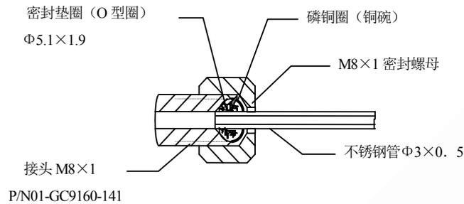
图 2.3 金属管气路连接示意图
