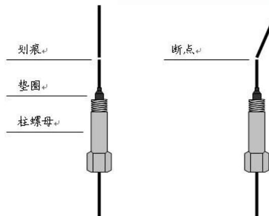
图 6.2 : 准备熔融硅毛细管柱
