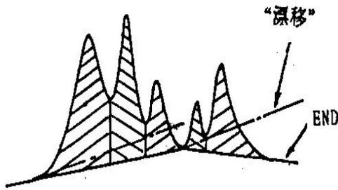
图3表示不完全分离峰与设定漂移的关系。产生不完全分离峰的初峰时，从其开始点S划出漂移的倾斜线。峰与峰之间的谷V1和V2在漂移的线之上，但V3在线之下，所以连接S点和V3点划出基线，从V1和V2引出垂线分别求出峰A、B、C的面积，从V3，即从D峰的起始点再次划出漂移的倾斜线，
