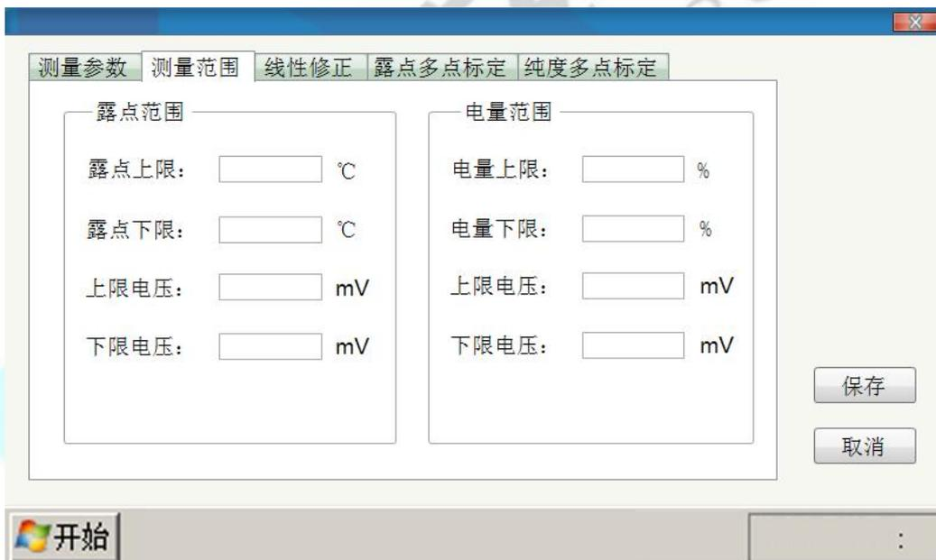
测量范围界面中，用户可以定义露点的上下限以及上下限测量电压，电量的上下限以及上下限测量电压。
