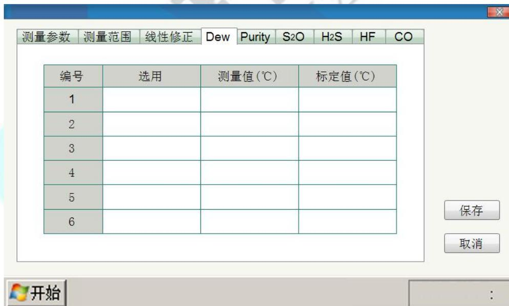
多点标定界面中，用户可以定义露点、纯度、SO<sub>2</sub>、H<sub>2</sub>S、CO 的多点标定参数。用户最多可以定义 5 点标定。点击保存按钮则保存用户定义的输入。点击取消则忽略用户输入。点击关闭则回到主界面。
