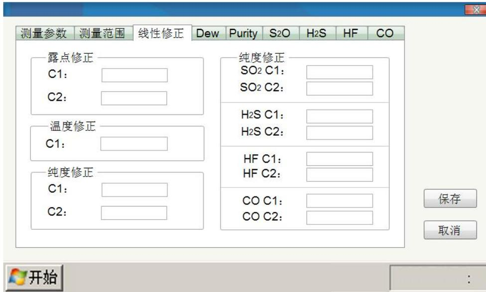
线性修正界面中，用户可以定义露点线性修正的斜率参数以及截距参数，温度线性修正的截距参数。点击保存按钮则保存用户定义的输入。点击取消则忽略用户输入。
