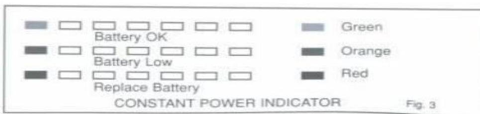
另一种为电池测试状态。按下电池测试键进行电池测试。测试时发光二极管以三色图谱指示电池的实际电压。（见图 4）
