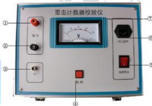
1-2、输出端 3、接地 4、检测键 5、电源开关 6、AC220V插座 7、电压指示
