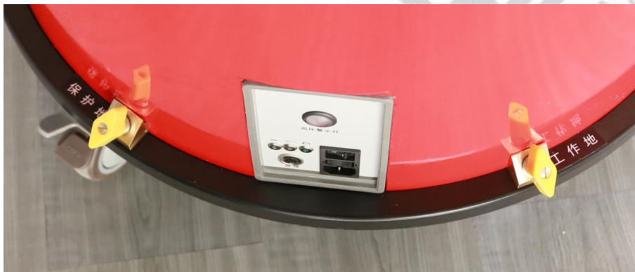
图 6-9 阻尼振荡主机接地
