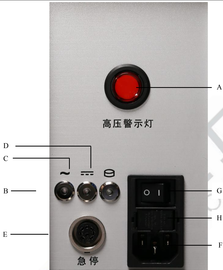
图 6-8 阻尼振荡波单元前面板
