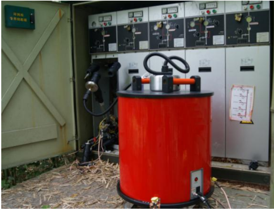
图 6-7 HZZDB-30 测试现场连接图
