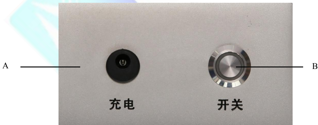
图 4-3 HZCAL-100 标准放电脉冲校准器充电和开关/指示灯面板
