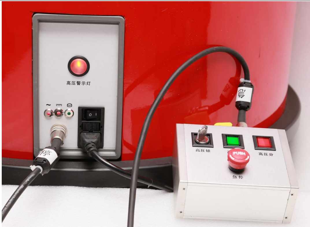
图 3-1 HZZDB-30 和外部安全控制单元连接
